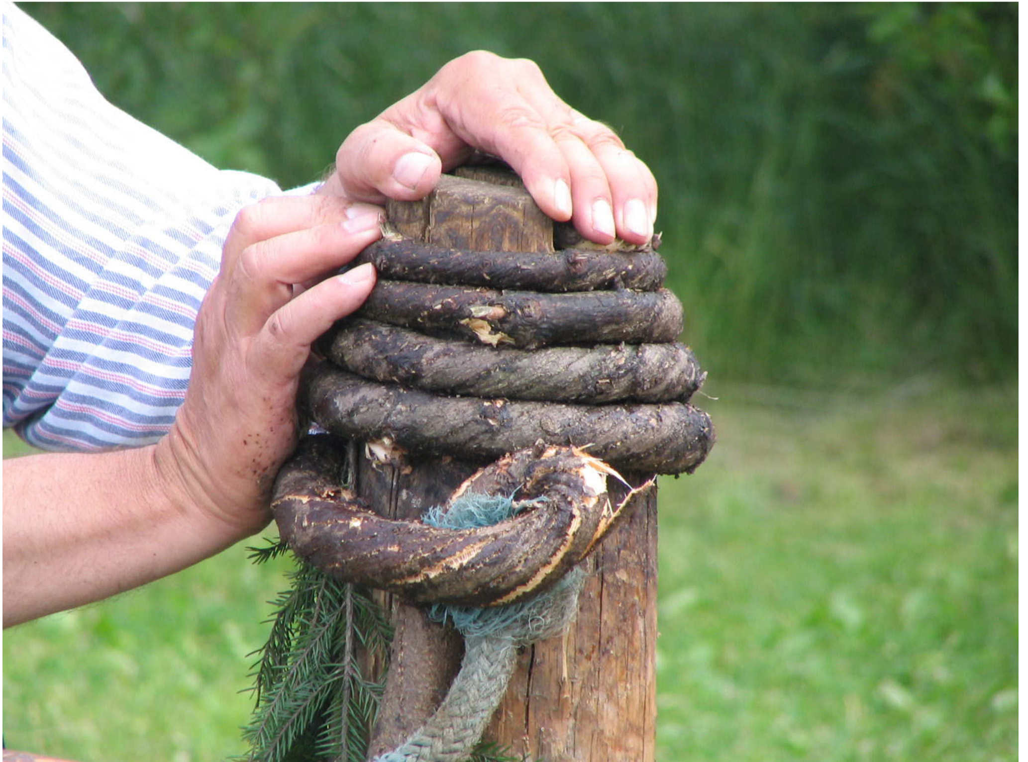
Huhtikuussa ennen uiton alkua, väännettiin närelenkit puomipuiden yhteen liittämiseksi.
